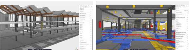
Modello BIM - Impianti / BIM model - MEP
